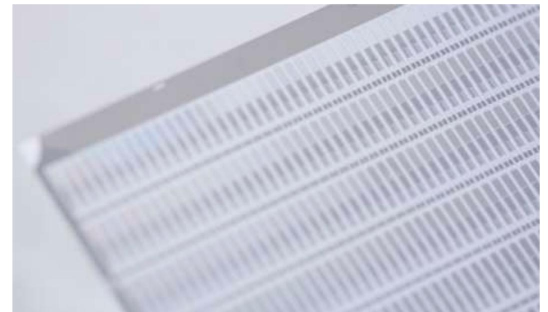
Sensorsubstrat nach dem Durchlaufen der Reinraum-Prozesse.
